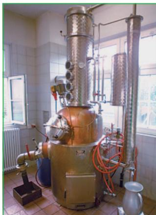
nicht zu stören, eine Entnahme von Destillat nur sehr langsam erfolgen darf. Der aufgesetzte Katalysator dient zur Oxidation störender Begleitstoffe wie z.B. von Cyanwasserstoff (»Blau-säure« aus den Steinen von Steinobst wie z.B. Kirschen und Zwetschgen).
